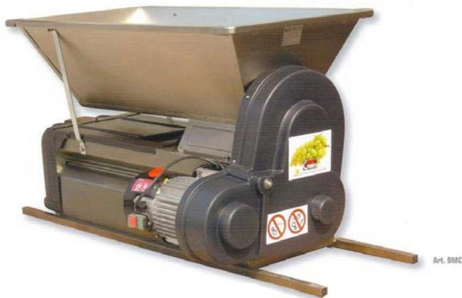
Прибор состоит из загрузочного бункера, в котором происходит отделение гребней от ягод. Внизу загрузочного бункера находится шнек для загрузки винограда. Шнек выталкивает виноград к валам дробилки, которые раздавливают его.
